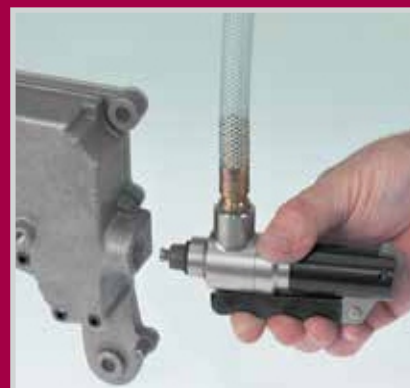
2 将FasMate插入螺纹孔
