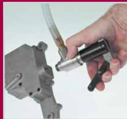
1 压动把柄使前端螺纹夹口收缩
