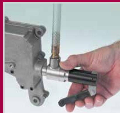
3 释放连接器把柄, 使前部螺纹夹口外扩锁紧接头, 实现密封。
