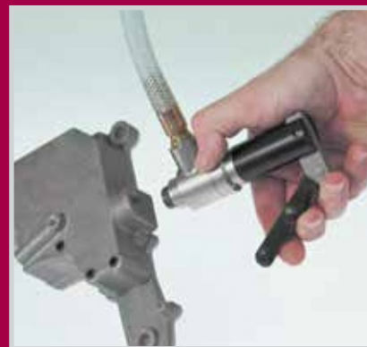
1 压动把柄使前端螺纹夹口收缩
